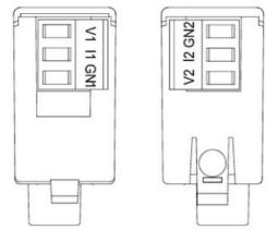
Connessione per uscita di corrente Current output connection Connexion pour sortie en current Conéxion salida corriente
