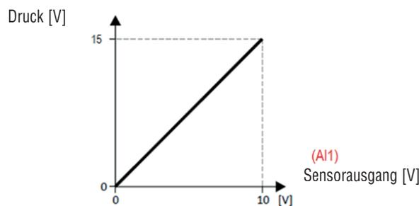
Das bedeutet: Sensorausgang 0V, Druck 0 Bar - Sensorausgang 10V, Druck 15 Bar - Sensorausgang 5V, Druck von 7,5 Bar, und so weiter.
