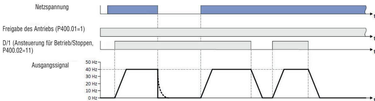
Achtung! Dieser Modus bewirkt einen automatischen Neustart des Motors, wenn am VLB3-Antrieb Spannung anliegt. Überprüfen Sie, dass alle Sicherheitsanforderungen erfüllt sind.
