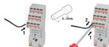
Zapojení vodičů zasunutím bez použití šroubováku
