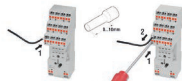
Werkzeuglose Push-in-Verdrahtung
