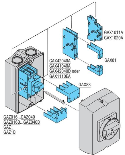
Es ist möglich, im Gehäuse 1 Anbaublock rechts und 1 links zu montieren, außer es ist bereits der vierte Pol montiert. Die Neutralleiter- und Schutzleiter-Klemmen sind am Boden des Gehäuses bereits vorhanden.
