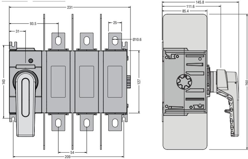
**GL0630C1 - GL0400C1UL mit zusätzlichem vierten Pol GLX420630 - GLX420400UL**
