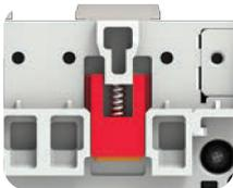
● **GLEITSCHUTZ FÜR DIN-SCHIENEN-MONTAGE**
