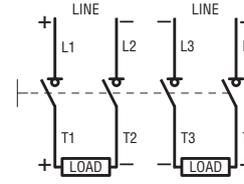
Der seitlich rechts am Trennschalter montierte Pluspol kann auch seitlich links befestigt werden. Folglich müssen die Anschlüsse geändert werden.
