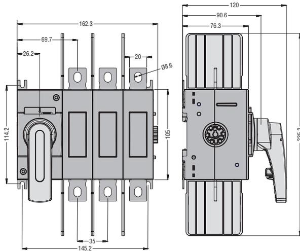
**GL0100C1UL - GL0200C1UL** mit zusätzlichem vierten Pol **GLX420100UL - GLX420200UL**
