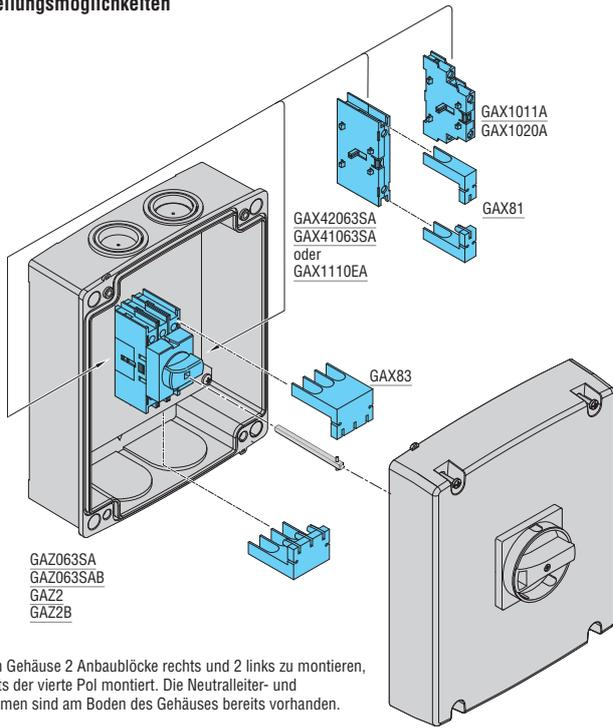
Es ist möglich, im Gehäuse 2 Anbaublöcke rechts und 2 links zu montieren, außer es ist bereits der vierte Pol montiert. Die Neutralleiter- und Schutzleiter-Klemmen sind am Boden des Gehäuses bereits vorhanden.
