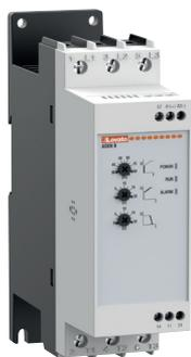
Solución ideal para quienes necesitan un arrancador de funciones básicas y configuración simple para el mero control del arranque y la parada gradual del motor. La configuración requiere el ajuste de solo 3 parámetros (escala de tensión inicial, rampa de aceleración y rampa de deceleración) mediante 3 **potenciómetros** instalados en el frente del arrancador.
