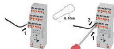
Втычное подсоединение push-in без использования отвертки
