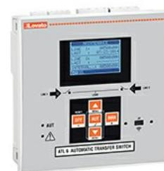
Commutatori di rete automatici per 2 linee di alimentazione, controllo trifase, con display LCD, alimentazione 110... 240VAC
