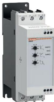
Soluzione ideale per chi necessita di un avviatore con funzioni base ed estremamente semplice da configurare, con il solo scopo di gestire l'avviamento e l'arresto graduale del motore. La configurazione richiede l'impostazione di 3 soli parametri (gradino di tensione iniziale, rampa di accelerazione e rampa di decelerazione) regolati tramite 3 **potenziometri** presenti sul fronte del soft starter.
