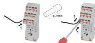
okablowanie wtykowe bez użycia śrubokręta
