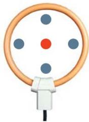
In tale condizione, la soluzione LOVATO Electric offre una prestazione di accuratezza pari allo 0.5%. Tuttavia, spesso non è possibile rispettare questo vincolo, ottenendo piuttosto un passaggio del cavo in prossimità dei punti indicati in blu, ovvero vicino alla
