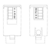
Connessione PT100 2 fili 2 wire PT100 connection Connexion PT100 à 2 fils Conexión PT100 de 2 hilos
