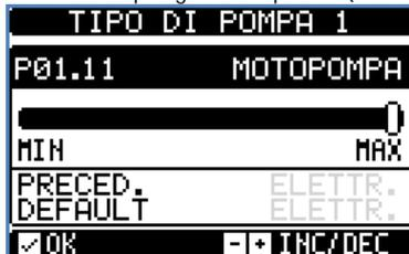
Al termine del setup il pannello si riavvia con la nuova configurazione. I parametri del menu setup vengono impostati automaticamente in funzione delle scelte effettuate, inclusi i testi degli allarmi e le loro proprietà.
